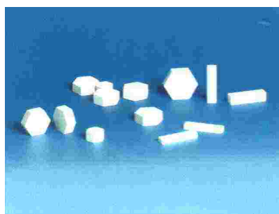
Mosaïques de revêtement
